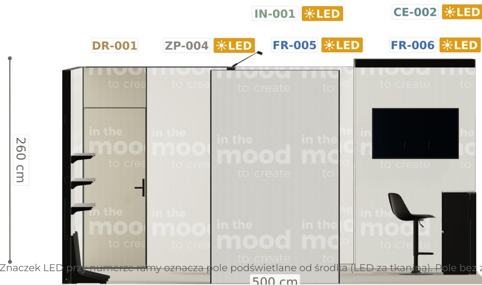
Elewacja ściany prawej
