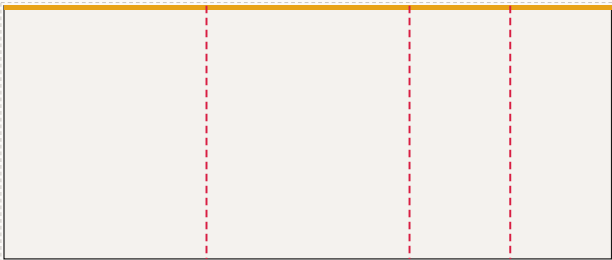
Ściana tylna od lewej: FR-001 ..., FR-004, LED 600 × 250 cm plik 603 × 253 cm, spad 1,5 cm po obrysie, łączeń: 3
