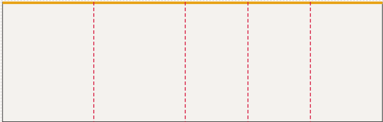
Ściana tylna od lewej: FR-001 ... FR-005, LED 791 × 250 cm plik 794 × 253 cm, spad 1,5 cm po obrysie, łączy: 4
