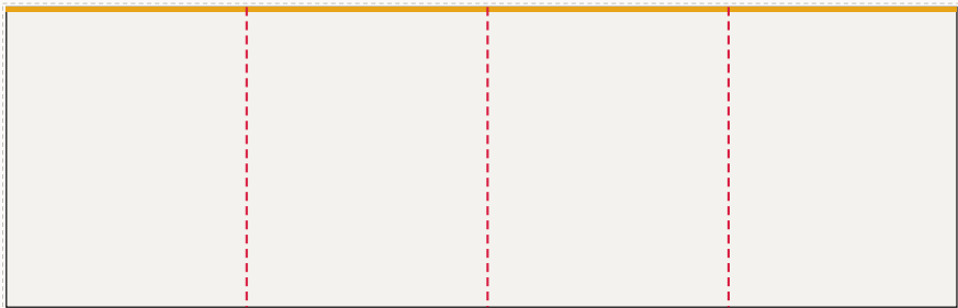
Ściana tylna od lewej: FR-001 ... FR-004, LED 791 × 250 cm plik 794 × 253 cm, spad 1,5 cm po obrysie, łączeń: 3
