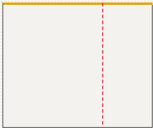
Ściana tylna, część 2 z 2 od lewej: FR-003, FR-004, LED 300 × 250 cm plik 303 × 253 cm, spad 1,5 cm po obrysie, łączeń: 1
