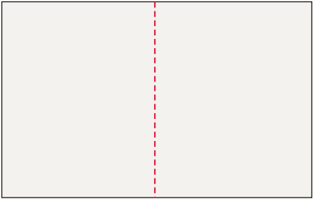
Ściana tylna, część 1 z 2 od lewej: FR-001, FR-002 395 × 250 cm plik 398 × 253 cm, spąd 1,5 cm po obrysie, łączeń: 1
