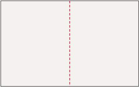
Ściana tylna, część 2 z 2 od lewej: FR-004, FR-005 400 × 250 cm plik 403 × 253 cm, spąd 1,5 cm po obrysie, łączeń: 1
