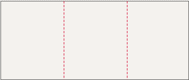
Ściana lewa od lewej: FR-010 ... FR-008 596 × 250 cm plik 599 × 253 cm, spad 1,5 cm po obrysie, łączeń: 2
