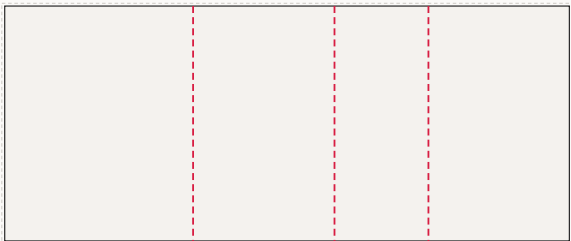
Ściana tylna od lewej: FR-001 ... FR-004 601 × 250 cm plik 604 × 253 cm, spad 1,5 cm po obrysie, łączęń: 3
